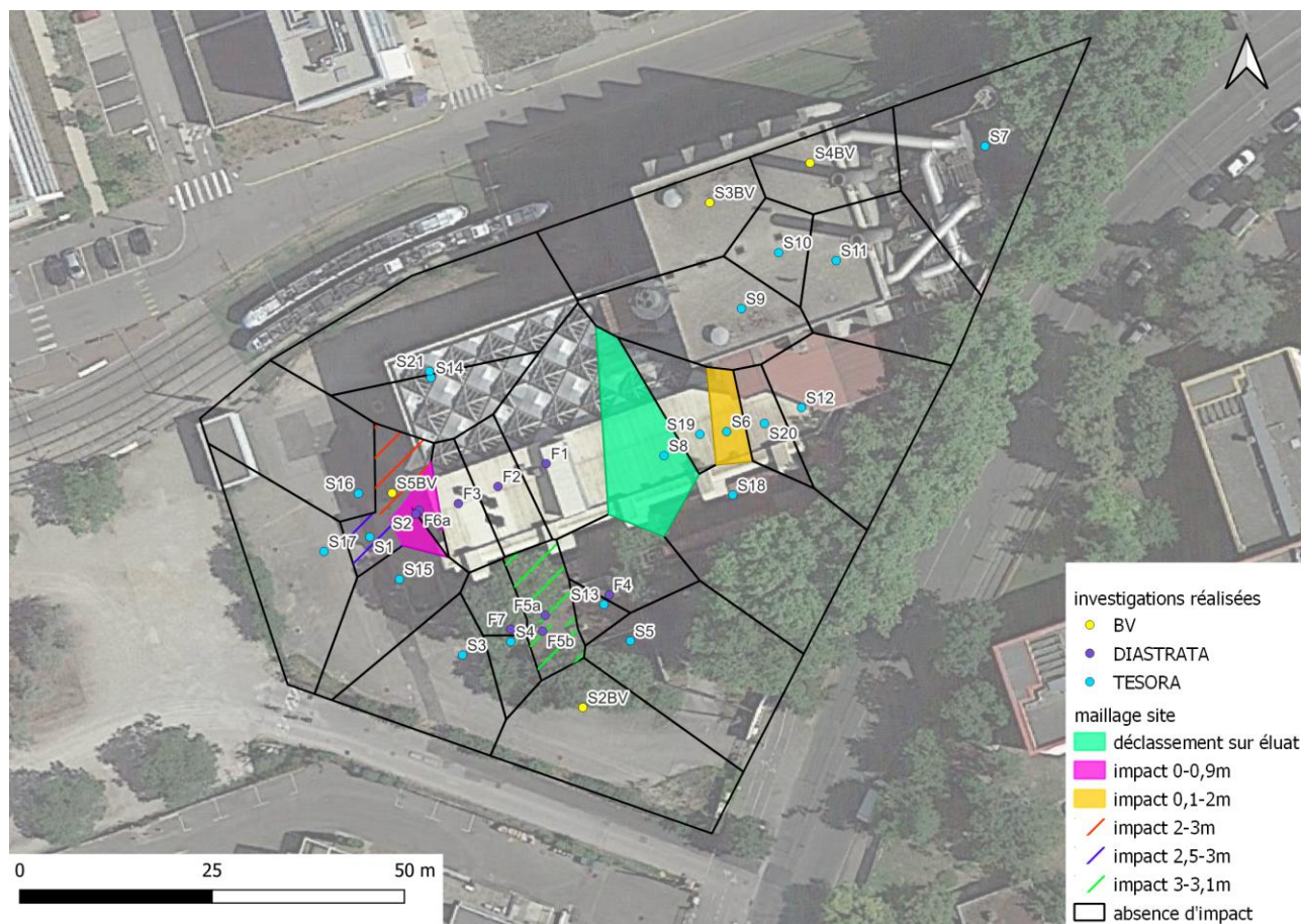
Figure 18 : Mailles et profondeur d'horizons impactés à excaver au droit du site
